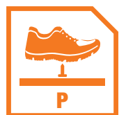
P RESISTENZA ALLA PERFORAZIONE (inserto metallico) con punta conica da 4,5 mm / RESISTANCE TO PERFORATION (metal insert) with 4.5 mm conical tip / RÉSISTANCE À LA PERFORATION (insert métallique) avec pointe conique 4.5 mm
