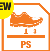
PS RESISTENZA ALLA PERFORAZIONE (inserto non metallico) con punta conica Small 3 mm / RESISTANCE TO PERFORATION (non metal insert) with 3 mm Small / RÉSISTANCE À LA PERFORATION (insert non métallique) avec pointe conique Small 3 mm
