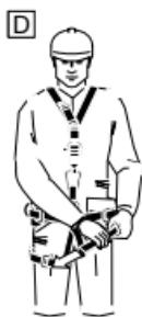
D. Fissare e regolare le cinture femorali. Le estremità libere delle cinture devono essere messe in sicurezza con i lacci
