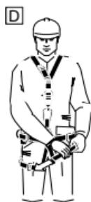
D. Legen Sie die Oberschenkelgurte an und justieren Sie sie. Sichern Sie immer die freien Enden der Gurte mit den Schlaufen.
